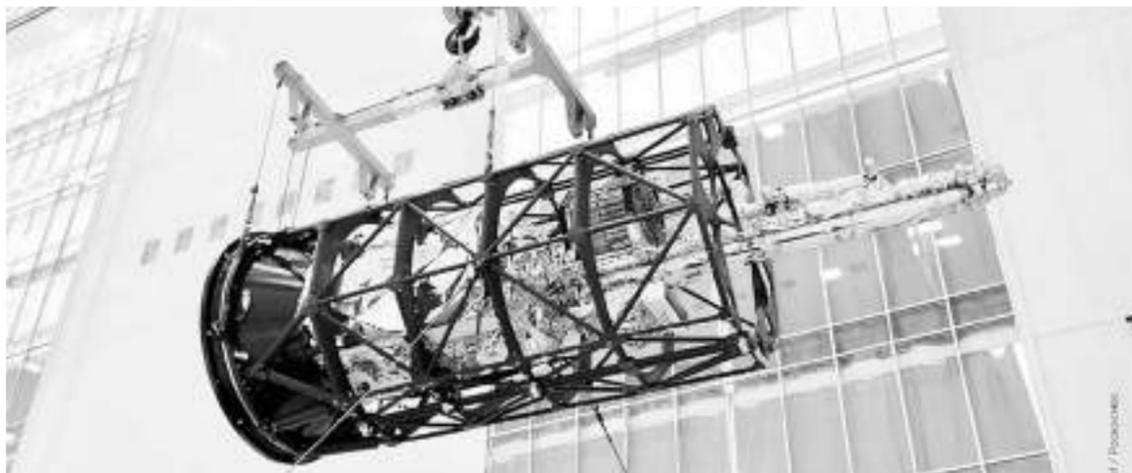
На обнинском научно-производственном предприятии «Технология» создан негерметичный корпус для первого российского радиолокационного спутника зондирования Земли.
